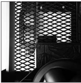
Näkyvyyttä parantavat aukot lattiassa
